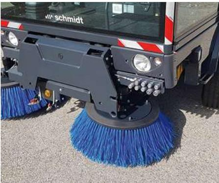
Un sistema flexible de barrido garantiza una limpieza impecable en cualquier situación. El sistema de cepillos, montado delante del eje delantero, tiene una anchura de barrido de 2.200 mm.
